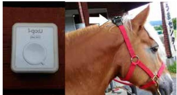
写真1 GPSデータロガー(左)と取り付け箇所(右)
