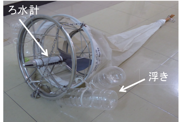
図2 ろ水計と浮き（ペットボトル）を装着したプランクトンネット
